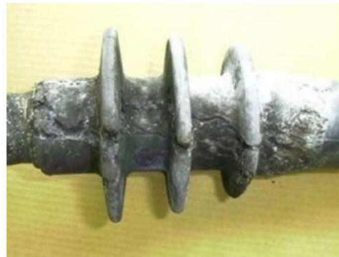
【終端接続部のトラッキングによる焼損事故事例<sup>(2)</sup>】
