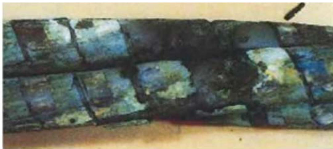
【遮蔽銅テープの破断による絶縁破壊事故事例<sup>(3)</sup>】
